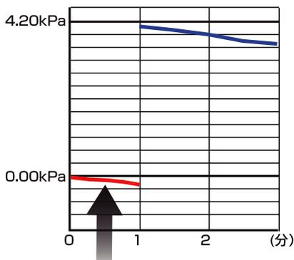
従来は青部分の漏洩試験による圧力低下のみで漏洩判断をしていました。
