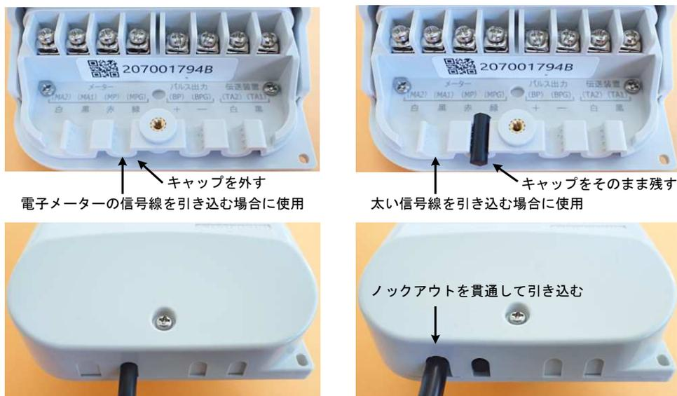
太い信号線を引き込む場合、虫などの侵入を防ぐため、キャップを取り付けたままにします。
